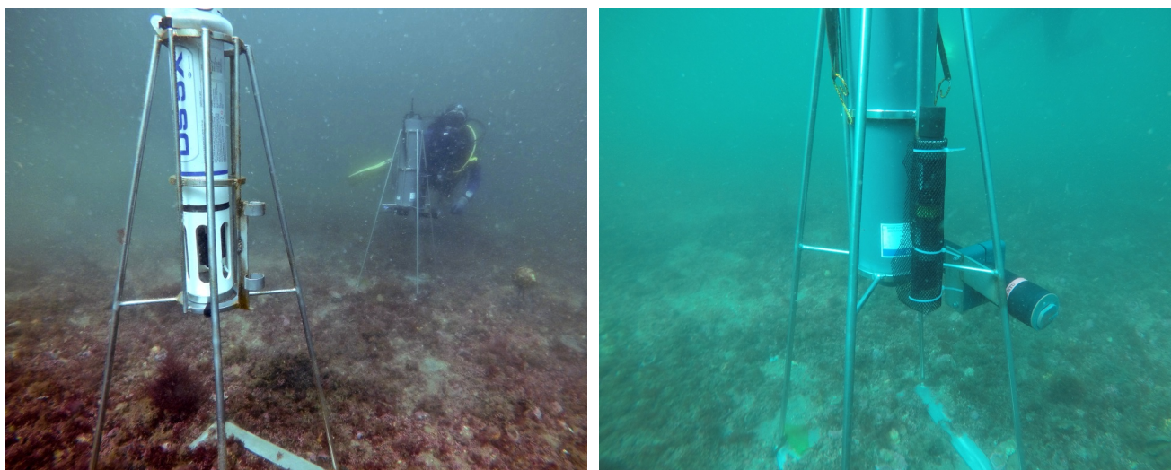
Figure 7 : Vue du site sous-marin d'instrumentation du banc du Roz (Baie de Daoulas). Photo de gauche : jeux de sondes déployés sur le fond, photo de droite : détail des capteurs pH, STPS et ECO FLNTU.
