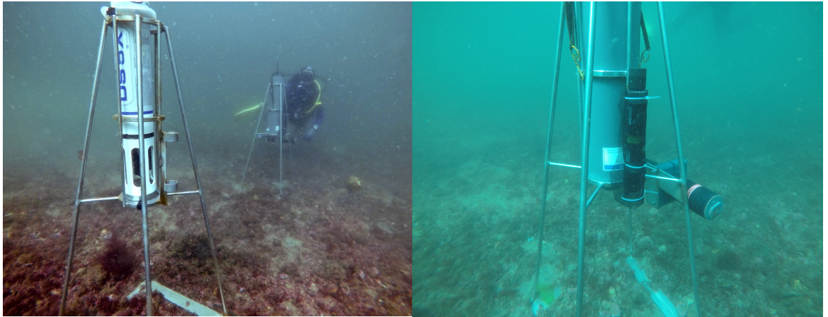
Figure 17 : Vue du site d'instrumentation sous marine du banc du Roz (Baie de Daoulas). Photo de gauche : jeux de sondes déployées sur le fond, photo de droite : détail des capteurs pH, STPS et ECO FL-NTU.
