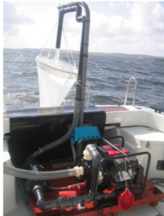
FIGURE 3.3 – Photographie du dispositif de pêche de larves par pompage ©Ifremer 2008.
