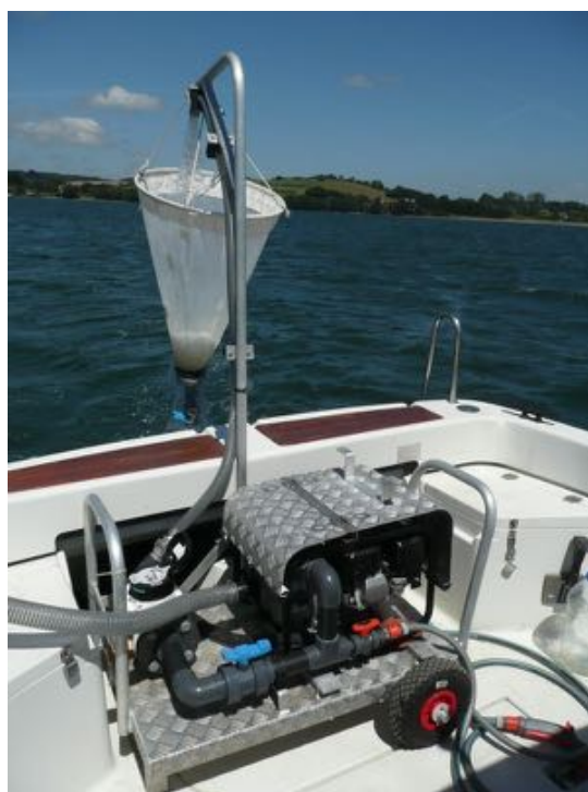
Figure 5 : Système de pompage et de filtration permettant la récolte des échantillons de plancton contenant les larves d'huîtres. La moto-pompe permet de filtrer 1,5 m 3 d'eau de mer en moins de 15 minutes. La maille du filet à plancton est de 40 µm. La mesure précise du volume pompé est fournie par un débitmètre. La crépine de prélèvements est lestée de manière à prélever à 1 mètre sous la surface. Lors du pompage, le bateau fait route au ralenti (vitesse inférieure à 1 nœud). Après pompage, le culot de filtration est transféré dans un flacon plastique de 2 litres tout en rinçant le filet. L'échantillon est formolé ou alcoolisé. Photo : © Cochet-environnement (2009). ►
